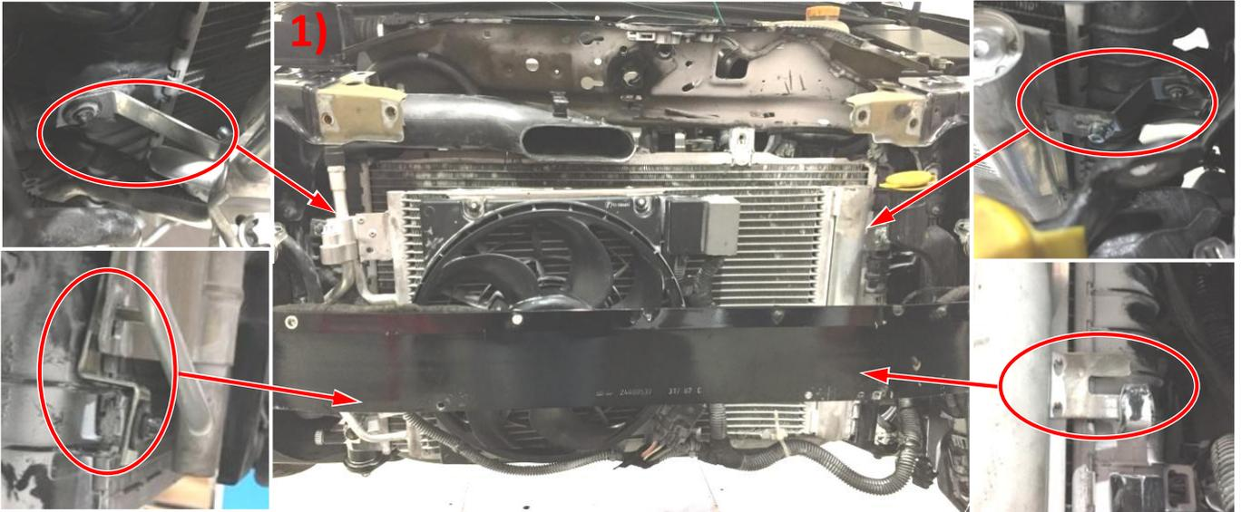
Die Gummilagerung vom Wasserkühler muss auf der Fahrerseite um 180° gedreht werden (2).
