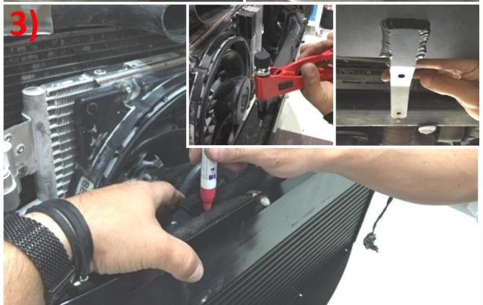
Befestigen Sie den Ladeluftkühler an den zuvor installierten Blindnietmutter. Nutzen Sie dafür das mitgelieferte Befestigungsmaterial (4).
